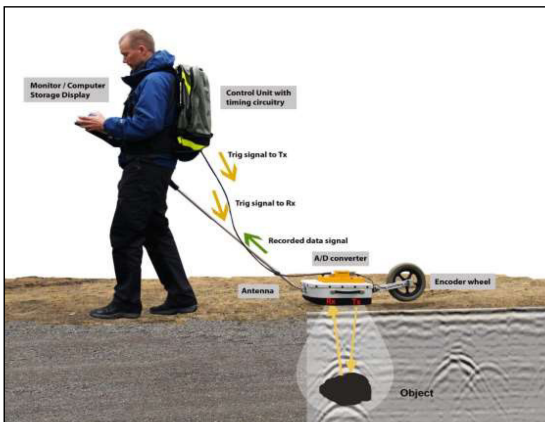
Slika 2. Prikaz načina snimanja tla georadarom i transmisije EM valova kroz tlo
